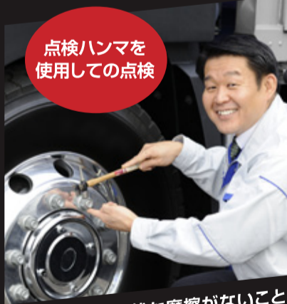
ホイール・ナット とボルトの点検
