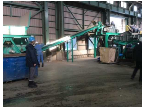
図表 32 破碎後ホッパーへ投入
