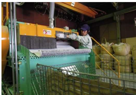
図表 31 破碎機での破碎の様子
