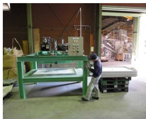
図表 30 アルミフレーム枠外し機
